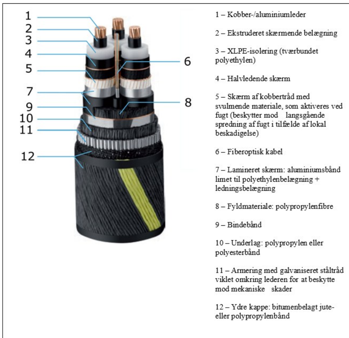
Figur 3.5 Eksempel af et højspændingsskabel (kilde: egne materialer baseret på: nexans.com)
