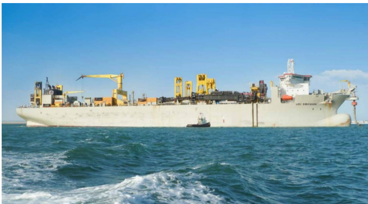
Figur 3.7 Eksempel på en muddermaskine med en sugetank (kilde: https://www.jandenul.com/sites/default/files/2020-05/Leiv%20Eiriksson%20%28EN%29.pdf )
