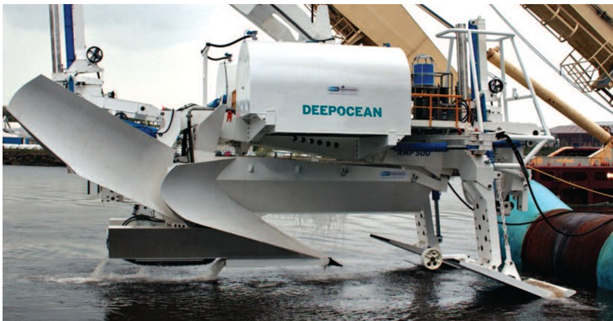
Figur 3.15 AMP500 avanceret flerstrækningsplov. Kilde: https://www.subsea-rov.com/services-assets/trenchers-ploughs/item/74-amp500
